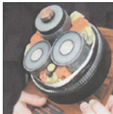
Offshorekabel 630 mm 2 Cu
