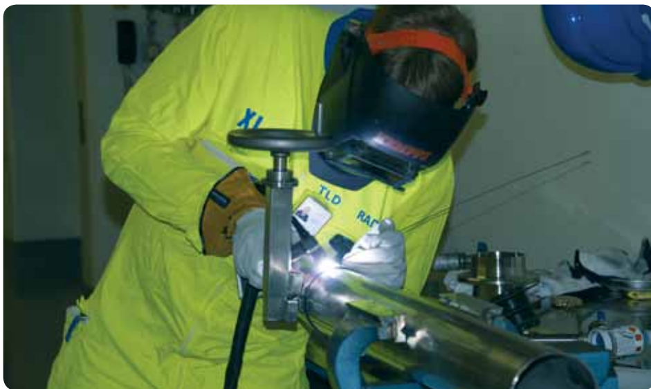
Patrik Gustavsson har tillgång till ett övningsrum där han kan öva svetsning. TIG-svetsning är den metod som används mest på Forsmark. Den genererar inte så mycket restprodukter, och renlighetskraven är höga på Forsmark.
